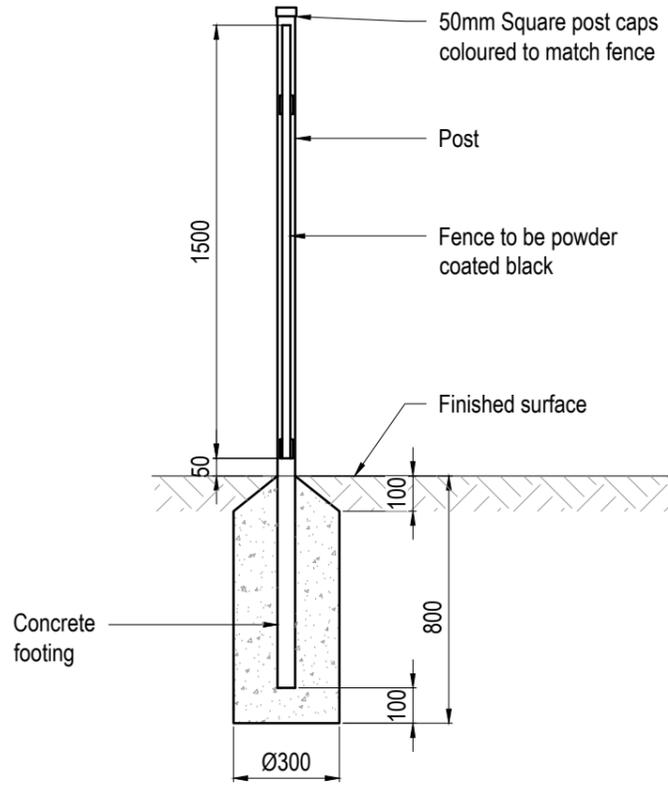
**ARC METAL TUBE STYLE SIDE VIEW**
