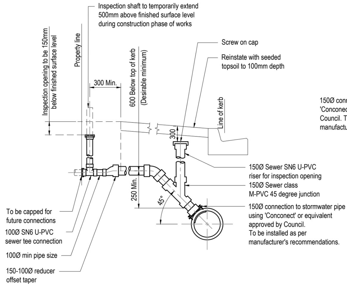
**CONNECTION TO STORMWATER PIPE UNDER KERBS**
